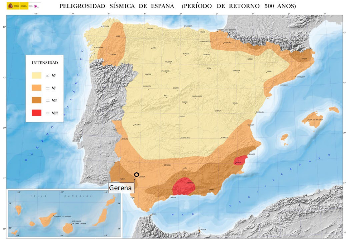
Ilustración 46. Mapa de peligrosidad sísmica de España para un periodo de retorno de 500 años. Fuente: Instituto Geográfico Nacional (IGN).
